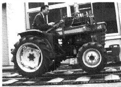
図1 農用トラクタの共振時ジャンプ
