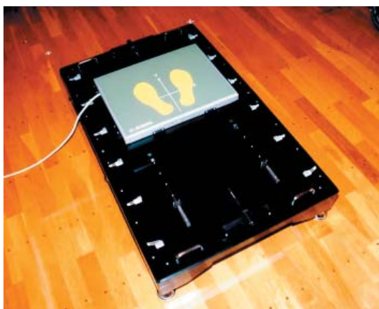
写真-1 重心動揺計（支持基台と可動式床面（重心検出部））
