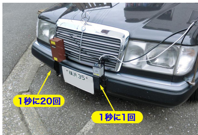
フロントバンパーにセットしたレーザ距離センサ
